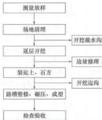
图 2B311013 路堑施工工艺流程
